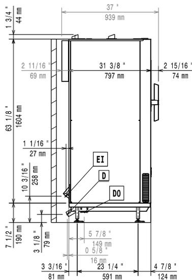
CW11 = Kaltwasserzulauf                      EI = Elektroanschluss
